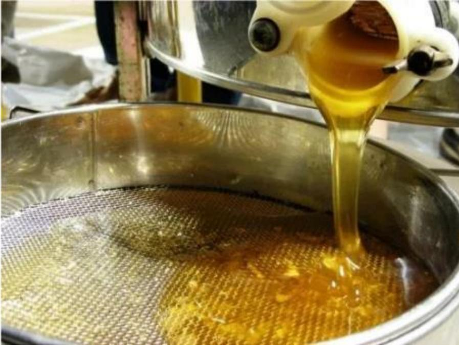
Il miele caduto sul fondo dello smielatore viene fatto fuoriuscire attraverso l'apposito rubinetto e messo dentro a un secchio. A questo punto avviene la filtrazione del miele, in modo da eliminare le impurità ancora presenti. Per fare questa operazione si utilizzano filtri in acciaio inox di diverse misure, e una volta filtrato, il miele viene versato dentro al maturatore a decantare, è questa l'ultima fase della smielatura.
